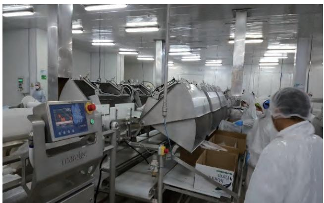
工場とは別に「Killing Station」を擁している。「Killing Station」では、沖合 200m の出荷筏より魚を直接フィッシュポンプで吸い上げ、頭と内臓を除去するまでの一次処理をする場所である。又、Marine Farm 社の加工場はトンネルフリーザーをいち早く導入し、他社と差別化した商品を作っている。処理量はギンザケを 30,000 尾 / 日、大西洋サケ（アトランティックサーモン）は 15,000 尾 / 日である。又、加工残渣はすべて魚粉工場に運ばれ、配合飼料（畜産用）の原料等に再利用されている。
