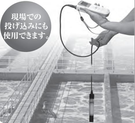
※投げ込み用電極は(pH METER, ORP METER, pH/ORP METER)にオプションにて対応しています。
