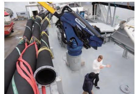
写真3 (左から) well boat の姿、コンパートメント操作部、魚を通すデッキ中央部のホース
