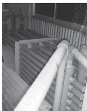
写真3-a 塩ビとチタンによる二重管式熱交換器
