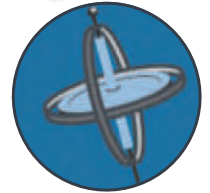
ジャイロスコープ 角度や傾きを検出する計測器
