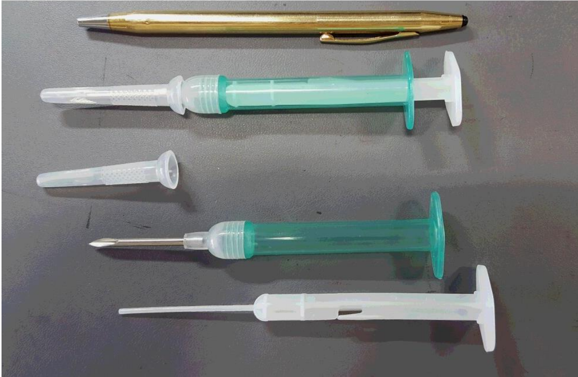
ヒラメ肉サンプリング用 インジェクター 12G 採肉重量 10~20mg=2mmφ×5~10mm
